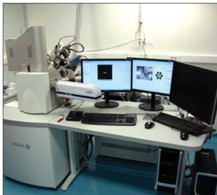
Fig. 2 - Sistemul dual SEM-FIB Tescan Lyra III XMU, instalat la INCDFM pentru prepararea de probe TEM și investigații structurale și compoziționale de suprafață
