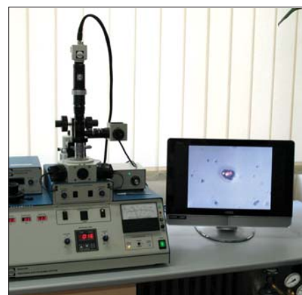
Fig. 3 - Instalație de subțiere ionică Gatan PIPS folosită la INCDFM pentru prepararea probelor TEM
