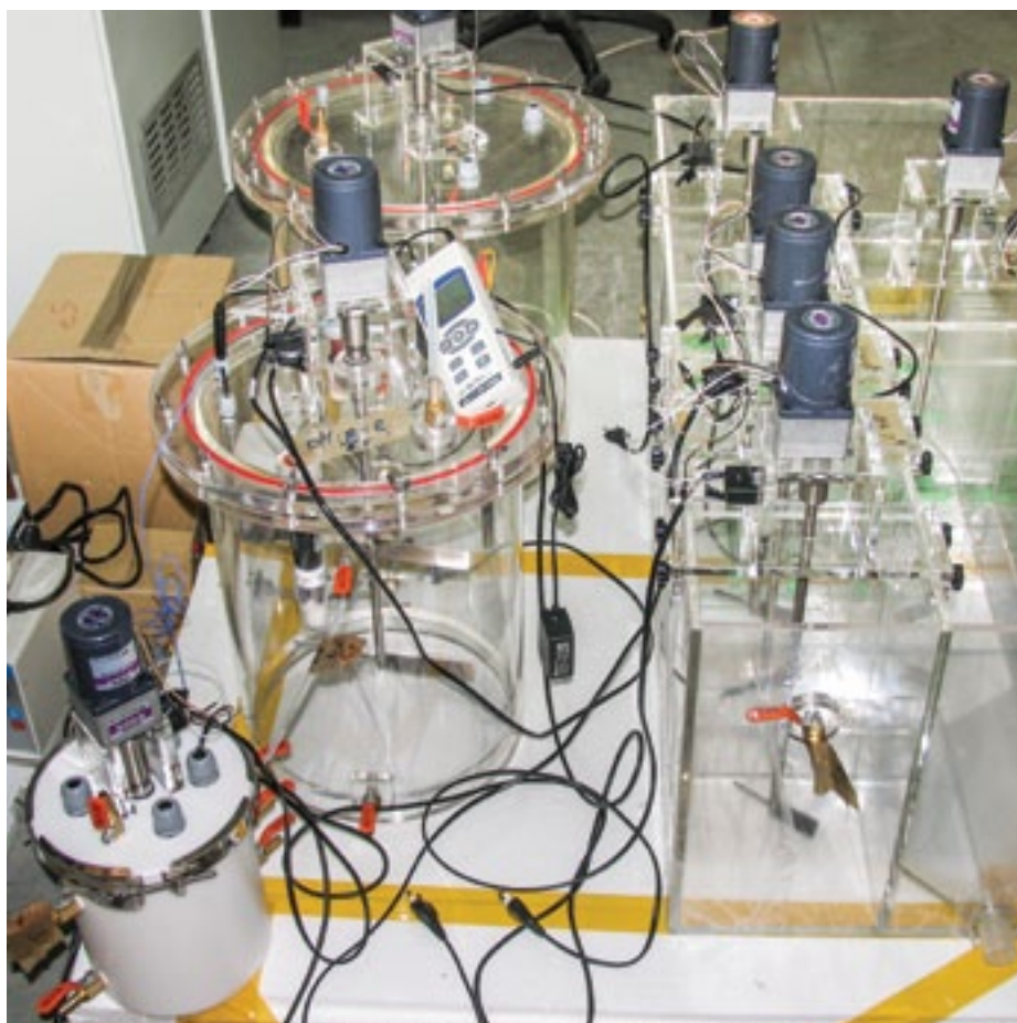
Bio-reactor cu membrane pentru epurare ape uzate și producere de biogaz
