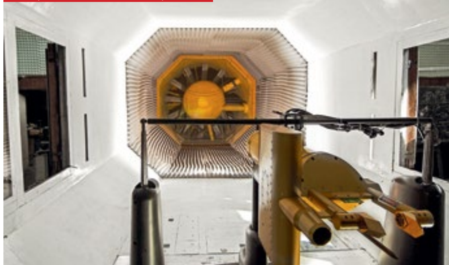
Zona experimentală în tunelul subsonic pentru HAIC
