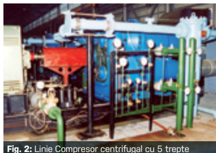
Fig. 2: Linie Compresor centrifugal cu 5 trepte
