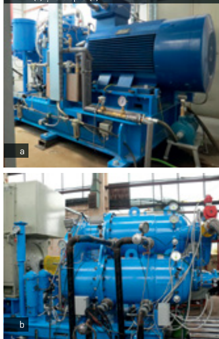
Fig. 1: Compresoare centrifugale cu 2 trepte (a) și 3 trepte (b)
