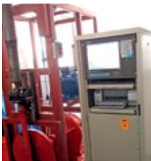
Stand pentru testarea și diagnosticarea computerizată a amortizoarelor pentru vehicule feroviare
