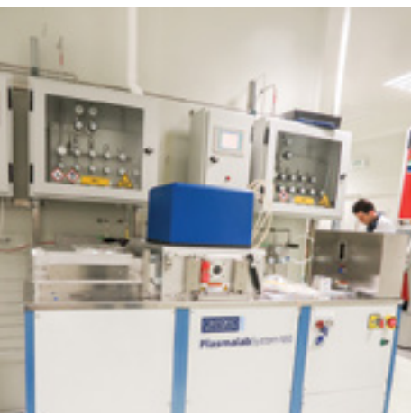
Fig. 1 Anumite echipamente trebuie să funcționeze în condiții de curățenie, cu atmosferă controlată (camera albă), folosind în procesul tehnologic gaze pure, care sunt debitate de un sistem special (Plasma Enhanced Chemical Vapor Deposition, IMT, centrul CENASIC, octombrie 2015)
