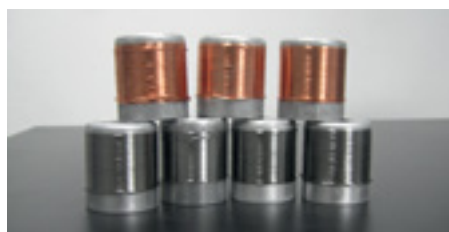
Mosoare cu microfire de cupru și pe bază de aliaj Fe-Si-B, izolate în sticlă, produse în ICPE-CA București
