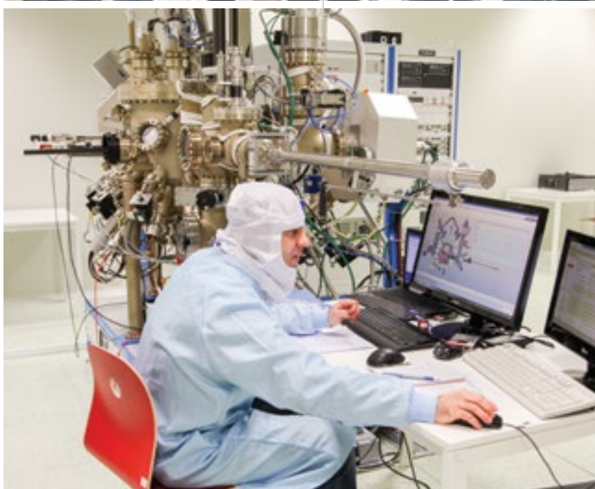
Echipamentul de epitaxie cu fascicul molecular (MBE) – producător RIBER, Franța. Dr. Emil Pavelescu (în imagine) s-a specializat în Finlanda și a adus CENASIC primul proiect internațional specializat (din programul Norvegia-România).
