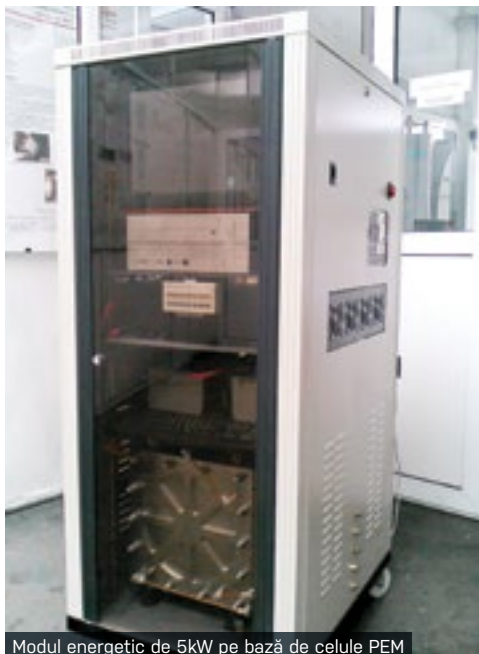
Modul energetic de 5kW pe bază de celule PEM
