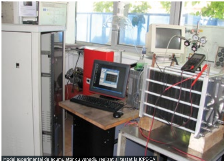
Model experimental de acumulator cu vanadiu realizat și testat la ICPE-CA
