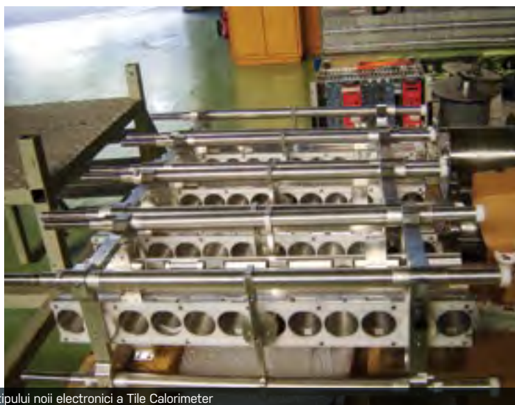
Testarea la CERN a prototipului noii electronici a Tile Calorimeter
