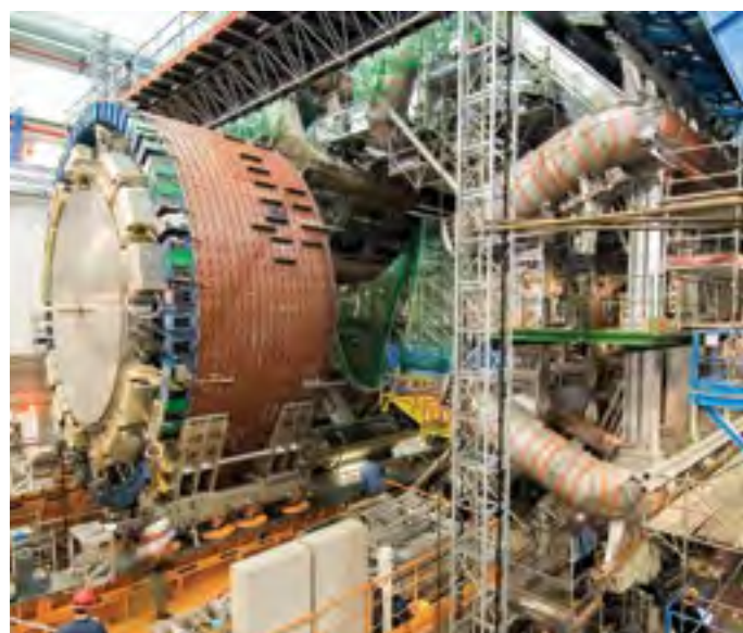
Montajul TileCalorimeter în incinta subterană ATLAS
