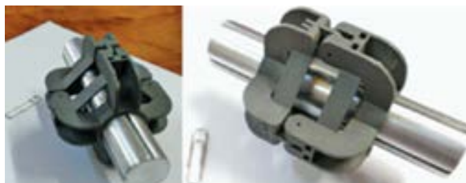
Figura 3 Senzorul de torsiune montat pe un ax (proiect ENIAC), demonstrator final TRL5. Pentru comparație, este alăturată o agrafă de birou. Acest tip de senzor asigură sensibilitatea, redundanța (4x) și miniaturizarea necesară, așa cum au fost specificate de către producătorul auto. Poate lucra până la 200°C la o turație de 10.000 rpm cu un coeficient de siguranță de 5 (adică raportul între stresul la curgere și cel maxim înregistrat în structură – este recomandat să fie minim 1,5 – 2).
