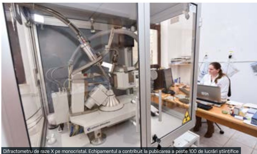
Difractometru de raze X pe monocristal. Echipamentul a contribuit la publicarea a peste 100 de lucrări științifice
