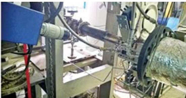
Testarea experimentală a sectorului combustor al JETIS la presiune și temperaturi ridicate, PIV, PLIF, măsurarea emisiilor
