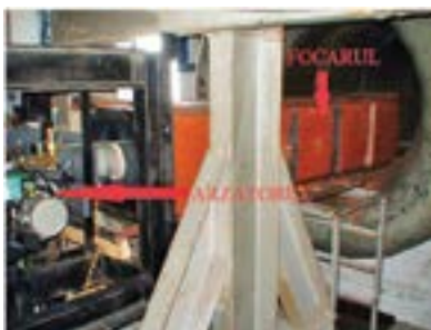
Instalația experimentală pe care au fost efectuate experimentele privind combustia uleiului de camelină și a amestecurilor acestuia cu kerosen
