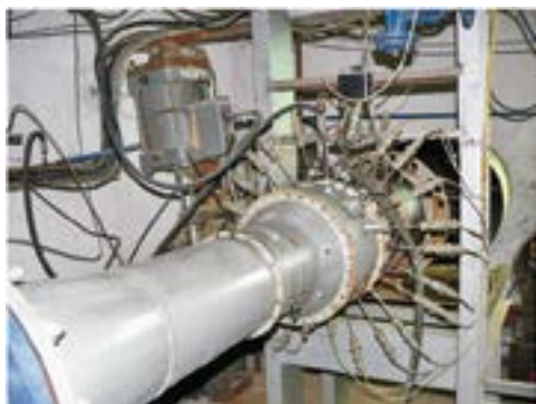
Linia 1 testare - Camera de ardere turbomotor 0,7 Mw
