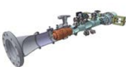
Instalație termogazodinamică la parametri înalți TEENI „Turboshaft Engine Exhaust Noise Identification” FP7-AAT-2007- 212367
