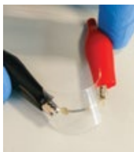
Figura 3. Diodă hibridă organic-anorganic transparentă și flexibilă
