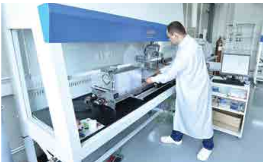
Echipamentul de printare straturi subțiri PERPHECT realizat de partenerul Optoelectronica-2001 S.A., aflat în prezent în custodia și la dispoziția INCDFM în centrul RiTec nou creat
