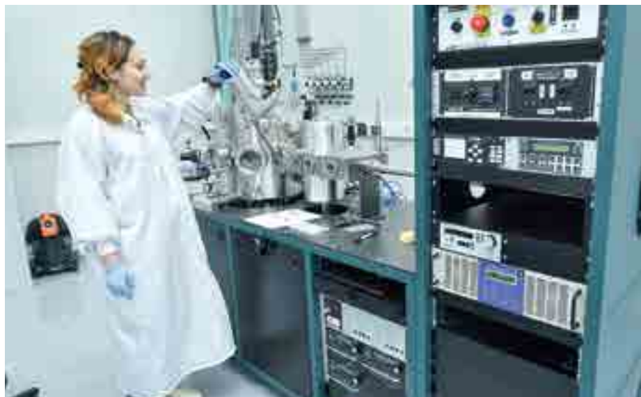
Dr. Cristina Beșleagă Stan și echipamentul nou achiziționat în 2016 pentru depunere de straturi subțiri prin pulverizare magnetron (5 catozi, diam. de 2 și 3 inch) RF-, DC-, și pulsed-DC, cu multiple facilități pentru control și monitorizare, și proces automatizat software, din centrul RiTecC nou construit al INCDFM
