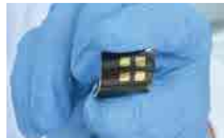
Celule solare flexibile obținute în cadrul proiectului PERPHECT. Eficiența maximă obținută a fost de 12,20% (medie de 10,2%)
