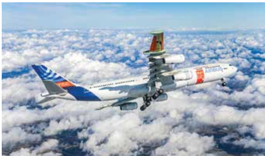
Aerona BLADE, singurul demonstrator operațional proiectat pentru curgere laminară
