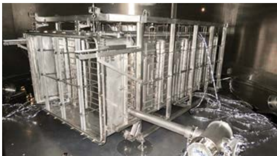
Figura 6. Incinta termică mică plasată în camera de testare Focal 6.5 (credit imagine: Centrul Spațial din Liege)
