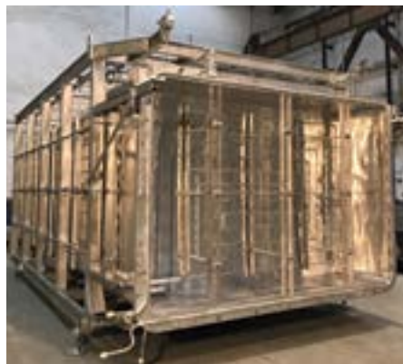
Figura 2. Incinta mică de testare a echipamentelor pentru spațiu dezvoltată în cadrul programului JUICE de către INCDT COMOTI și Centrul Spațial din Liege
