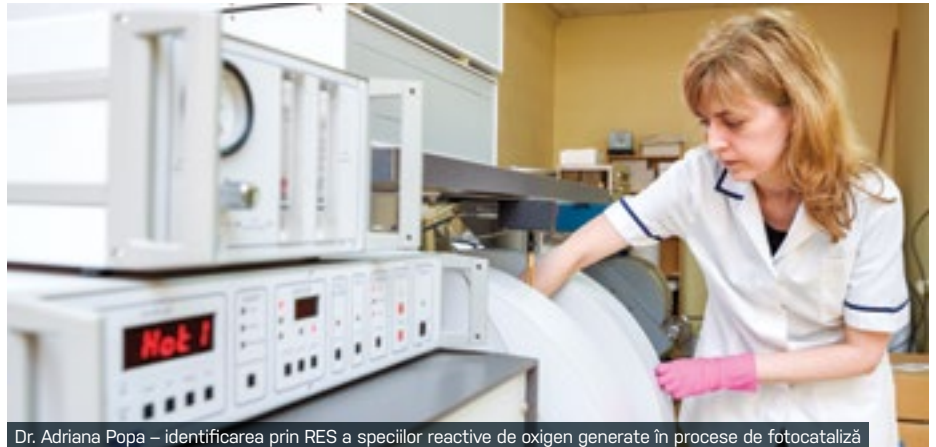
Dr. Adriana Popa – identificarea prin RES a speciilor reactive de oxigen generate în procese de fotocataliză
