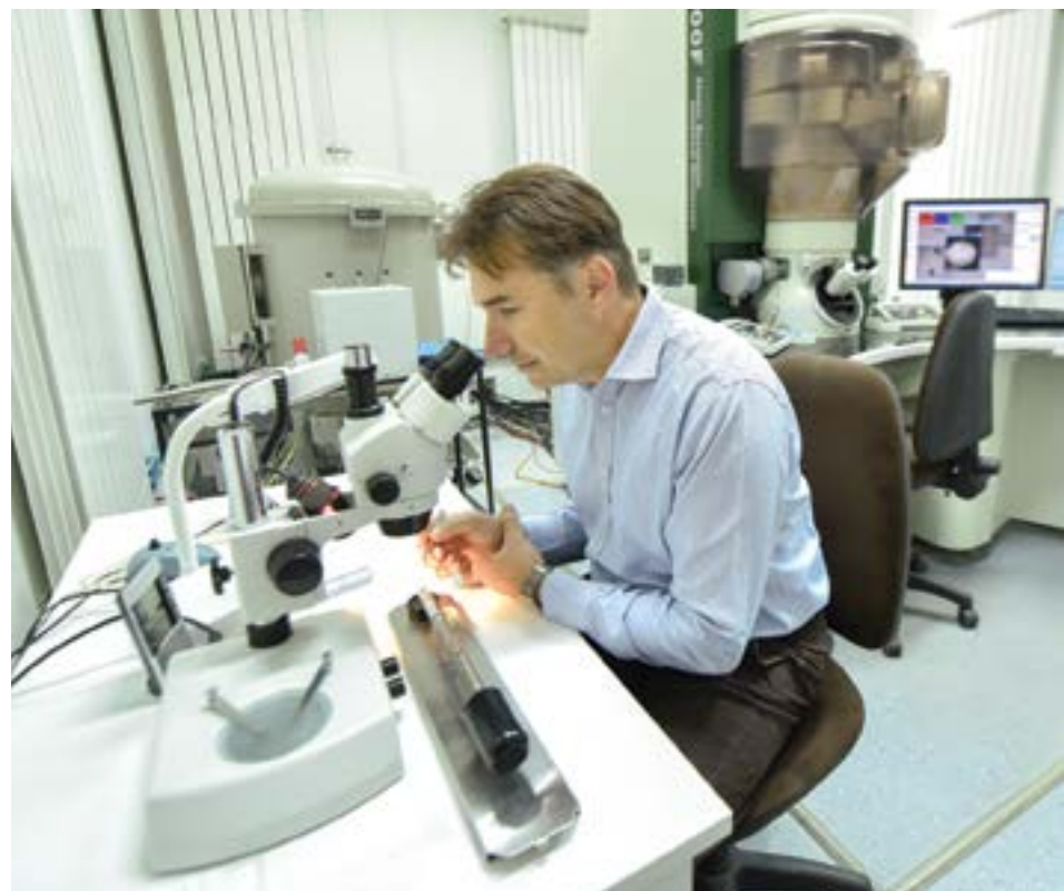
Caracterizarea microstructurală la scală atomică a nanomaterialelor folosind microscopiele electronice de înaltă și ultra-înaltă rezoluție instalate la INCDFM.
