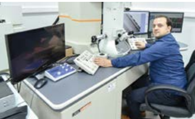
Caracterizarea microstructurală la scală atomică a nanomaterialelor folosind microscopiele electronice de înaltă și ultra-înaltă rezoluție instalate la INCDFM.
