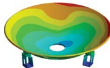
Rezultate analiză termoelastică - Deformații totale (partener HPS-RO)
