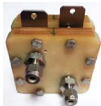
Model detaliat și model experimental de celulă de electroliză (Partener ICSI Rm. Vâlcea)
