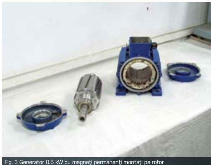
Fig. 3 Generator 0.5 kW cu magneți permanenți montați pe rotor
