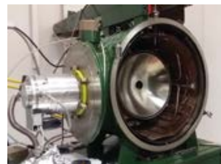
Reflector în facilitatea INOE2000 pentru teste climatice în condiții similare spațiului cosmic
