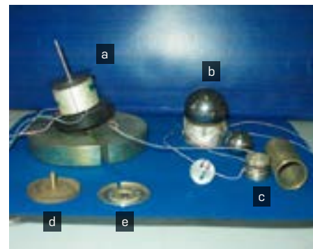
Fig.2 Primele micromotoare piezoelectrice rotative realizate în ICPE-CA (1996) a- Micromotorul MPR 33 cu rotor conic b - MPR 27 cu rotor sferic c- MPR 15 d- microrotorul unui micromotor disc e- convertorul micromotorului disc
