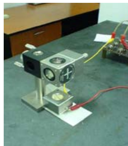
Fig.4 Sistemul Agilent Laser Interferometer-10766A cu care se trasează caracteristicile electromecanice ale unui actuator electromecanic
