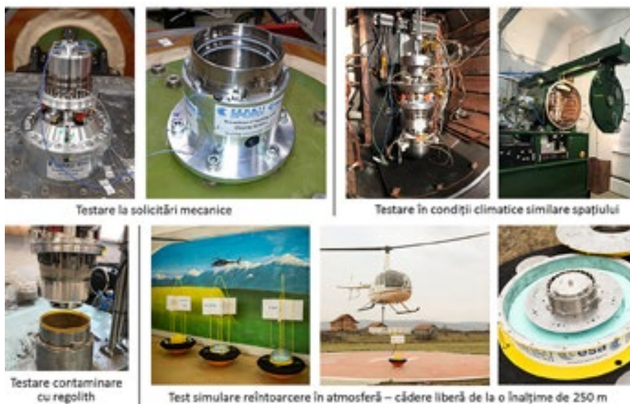
Fig. 4 Campanie de testare sistem de etanșare și închidere
