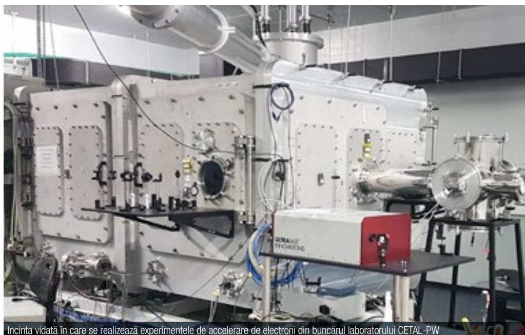
Incinta vidată în care se realizează experimentele de accelerare de electroni din buncărul laboratorului CETAL-PW
