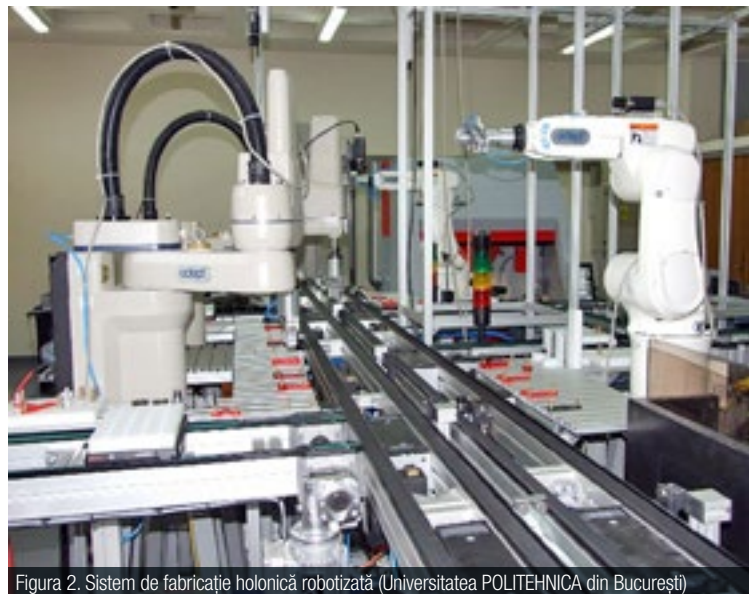
Figura 2. Sistem de fabricație holonică robotizată (Universitatea POLITEHNICA din București)
