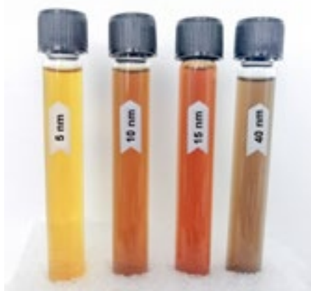
Nanoparticule de Ag sintetizate radiochimic
