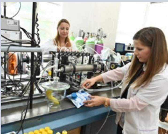
Dr. Cristina Achim și dr. Ana Bratu operând instalația de spectroscopie fotoacustică cu laser pentru detecția biomarkerilor
