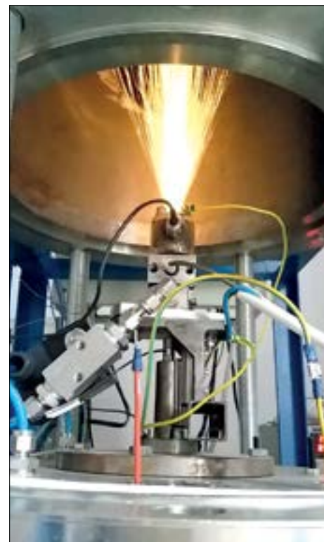
Stop-cadru cu jetul inițial la teste de aprindere \text{H}_2 + \text{O}_2 în atmosferă liberă
