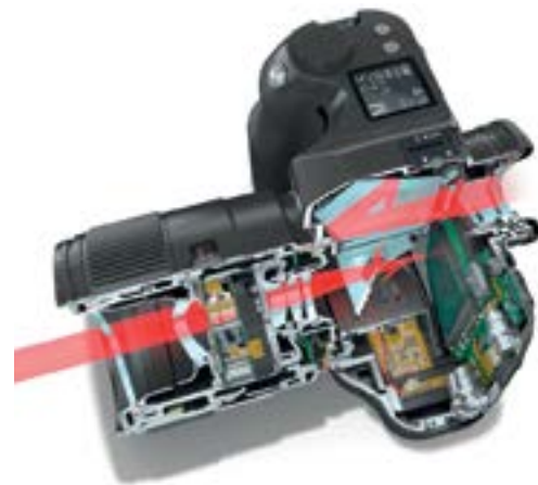
Secțiune prin camera foto DSLR Leica S3
