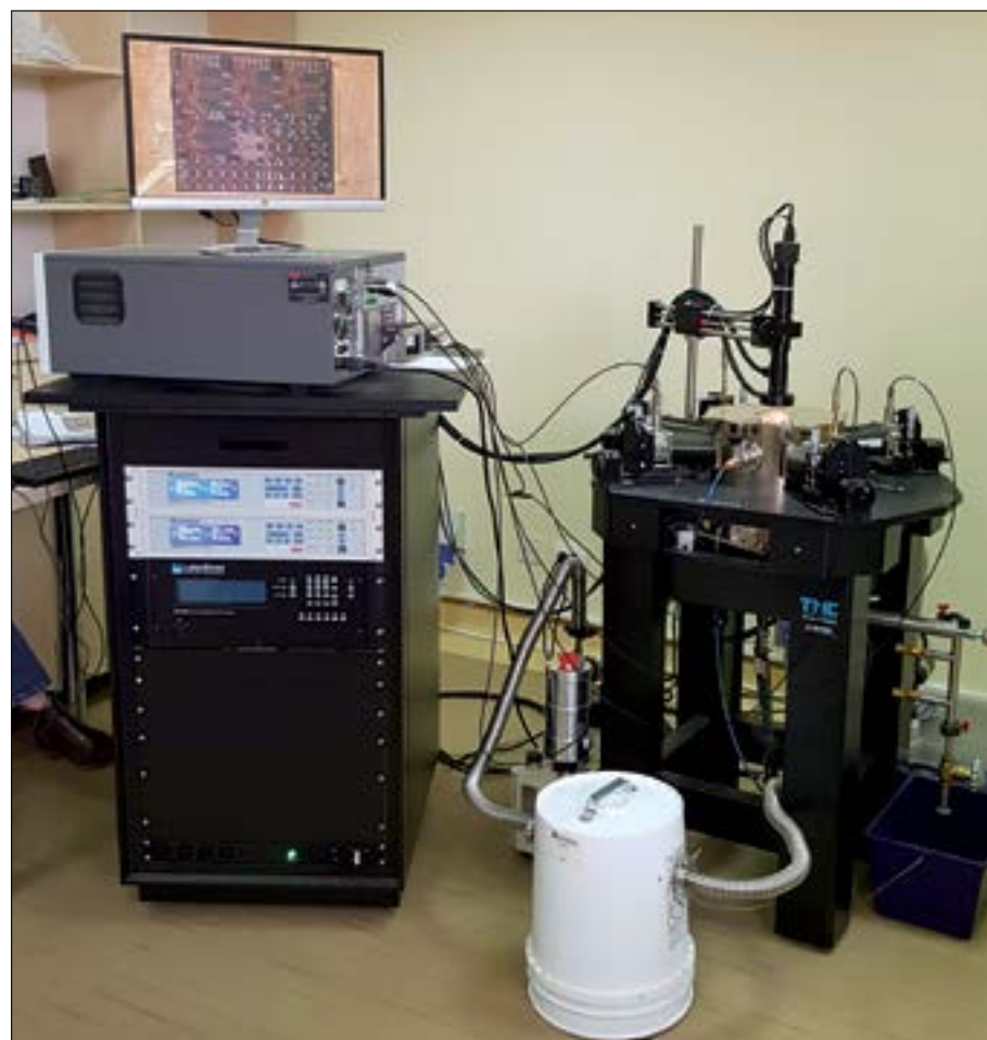
Echipament Lake Shore Cryotronics, Model CPX-VF cu He lichid, dedicat caracterizării I-V în câmp magnetic, la temperaturi joase (~2 K); Conectarea rezervorului criogenic de Helium la echipament
