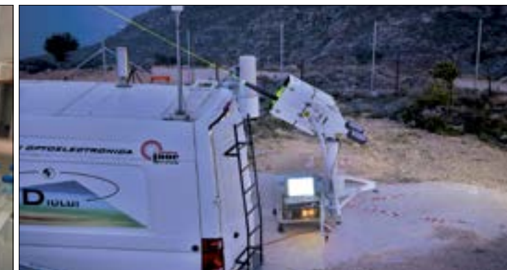
Sistemul lidar cu scanare măsurând proprietățile optice ale aerosolilor de praf mineral
