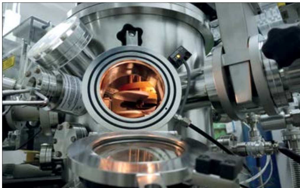
Echipament PLD (Pulsed Laser Deposition) cuplat cu RHEED pentru depunere filme subțiri. Sistem avansat, de ultimă generație
