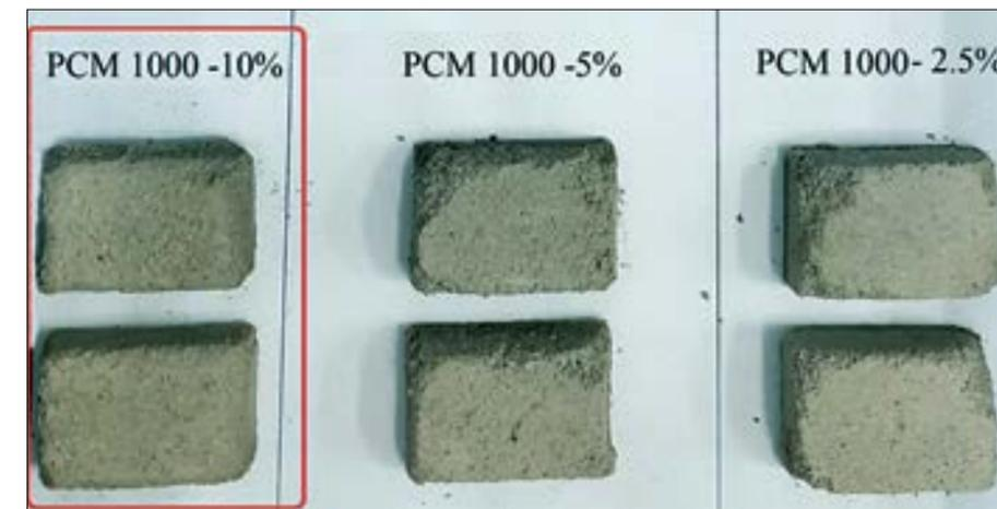
**Figura 3.** Aspectul produsului experimental optimizat (cărămizi cu capacitatea de stocare pasivă a energiei termice)
