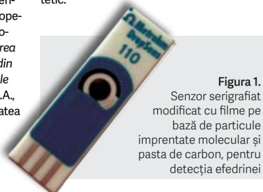
**Figura 1.** Senzor serigrafat modificat cu filme pe bază de particule impregnate molecular și pasta de carbon, pentru detecția efedrinei
