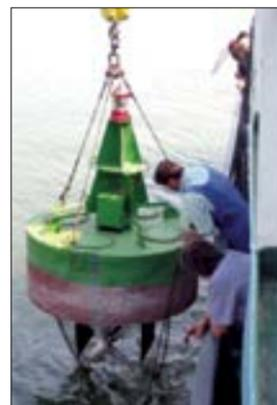
Hidrogenerator electric cu semnalizare luminoasă
