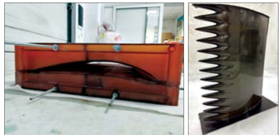
Matrițe tehnologice dezvoltate prin tehnologii de fabricație aditivă, structură profil aerodinamic paletă de stator ventilator din materiale compozite ranforsate cu fibre de carbon
