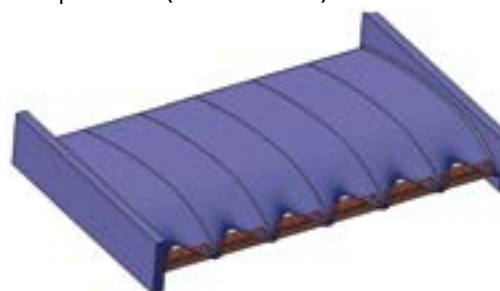
Concept pasiv de reducere a nivelului de zgomot produs de curgerea turbulentă care interacționează cu bordul de atac al paletelor de stator ale ventilatoarelor motoarelor de tip turbofan
