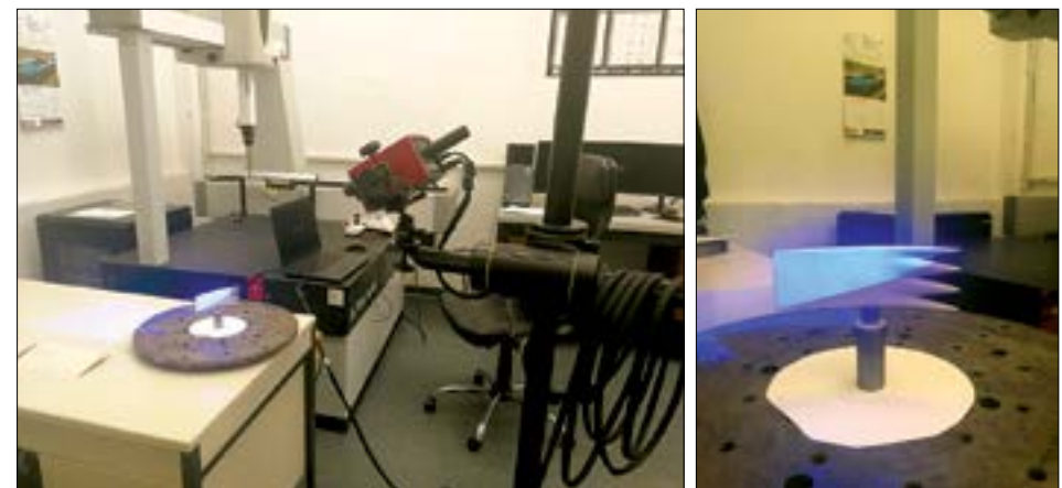
Măsurare dimensională 3D a profilului aerodinamic
