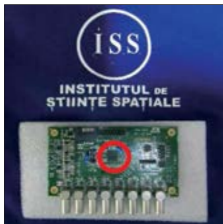
Chip-ul ASIC PADI-XII (indicat de cercul roșu) montat pe o placă de testare, așa cum a fost prezentat la Conferința și Expoziția ROSA-ESA Space and Security for Eastern Europe, 16-19 Mai, 2022.
