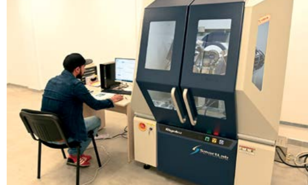
Sistem de difracție de raze X pentru analize structurale de ultimă generație
