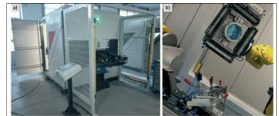
Prezentarea celulei robotizate de procesare laser a componentelor metalice cu aplicații în domeniul construcțiilor de mașini
