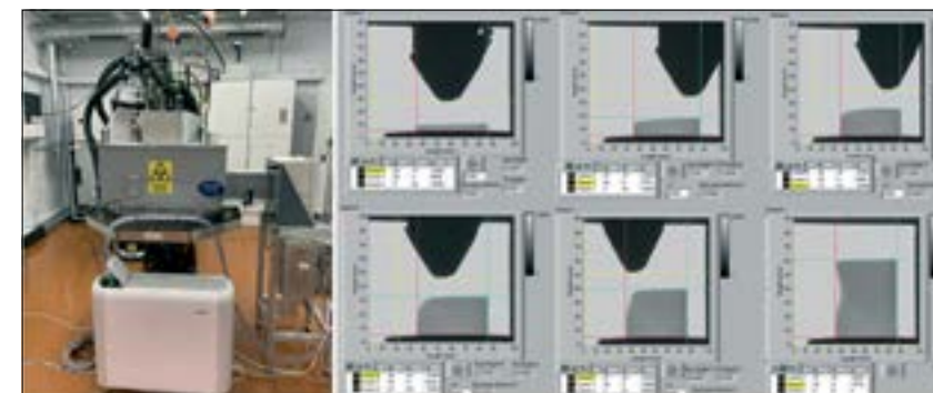
Sistemul pilot pentru identificarea în timp real a defectelor structurale apărute în procesele de fabricație aditivă cu laser
