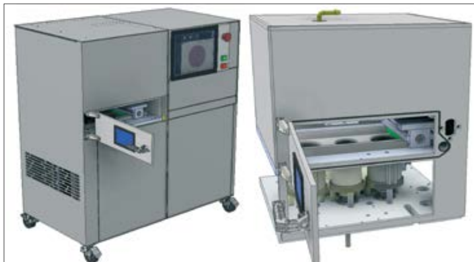
Sistemul integrat de procesare laser a materialelor metalice sub formă de pulbere în vederea obținerii de componente cu aplicabilitate în domeniul medical
