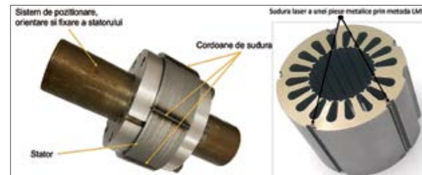
Pachet statoric îmbinat nedemontabil prin intermediul procesului de sudare laser
