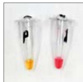
Foto 1: Reacție colorimetrică RT-LAMP (stânga - pozitiv, dreapta - negativ) după protocolul dezvoltat în cadrul proiectului
