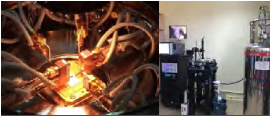
Laboratorul de microunde al IMT București. Echipament criogenic fabricat la Lake Shore Cryotronics, Columbus, USA, utilizat pentru măsurători ale tranzistoarelor la temperaturi extrem de joase (coborând la numai 1,53 K), în câmpuri magnetice intense (până la 2,5 T) și la frecvențe extrem de înalte (până la 67 GHz).
