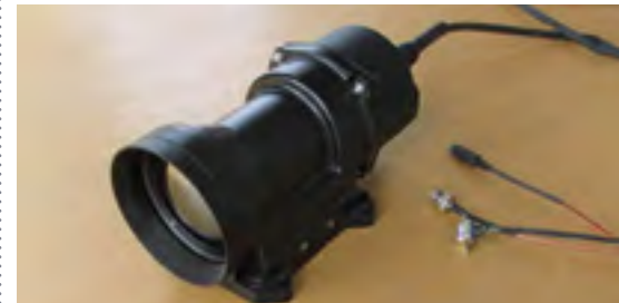
2. Sistemul SOFID realizat de Pro Optica împreună cu un detector LWIR fără răcire
