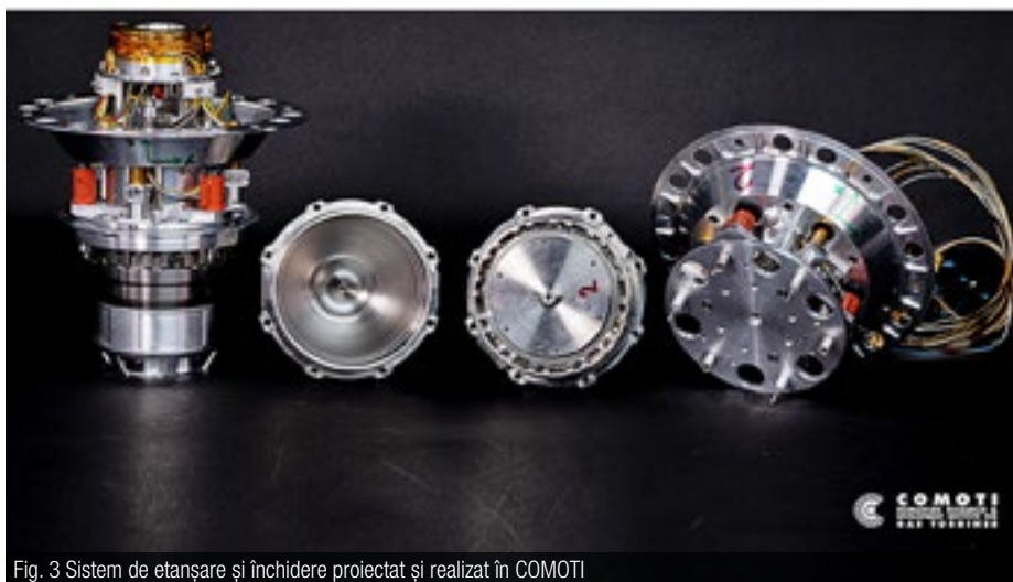
Fig. 3 Sistem de etanșare și închidere proiectat și realizat în COMOTI
