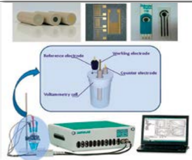
Electrozi de lucru a căror suprafață se modifică cu grafene și reprezentare schematică a standului de lucru pentru dezvoltarea de protocoale electrochimice de detecție
