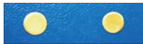
Fig. 3 Electrozii de detectare a biopotentialului electric, fabricați din Au, având diametrul și grosimea de: \Phi = 10 \text{ mm} \pm 0,1 \text{ mm} și h = 0,5 \text{ mm} \pm 0,05 \text{ mm}
