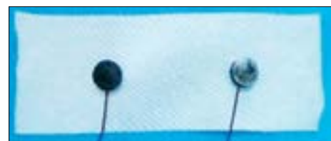
Fig. 2 Elementul sensibil al senzorului de bioimpedanță polarizat uscat cu electrozi realizați din material sensibil pe bază de hibrid nanocompozit Ag/polipirol, având diametrul și grosimea de: \Phi = 11 \text{ mm} \pm 0,2 \text{ mm} și h = 1,0 \text{ mm} \pm 0,1 \text{ mm}
