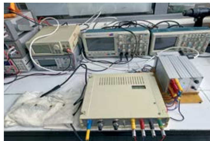
Fig. 5 Realizarea practică a sistemului complex de măsură a bioimpedanței, ca suport pentru dezvoltarea tehnicilor de impedanță cardiovasculară de utilitate clinică
