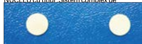
Fig. 1 Electrozi de injecție de curent, fabricați din Ag de puritate 99,99 %, având diametrul și grosimea de: \Phi = 10 \text{ mm} \pm 0,1 \text{ mm} și h = 0,5 \text{ mm} \pm 0,1 \text{ mm}
