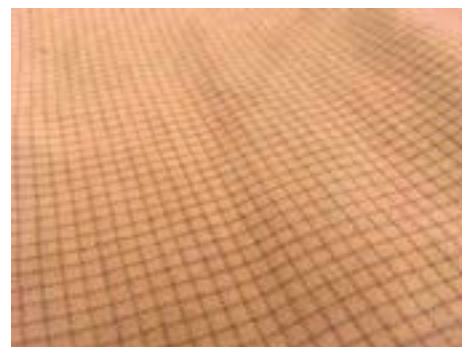
Grilele metalice sunt cunoscute și tratate ca un caz aparte în literatura științifică de compatibilitate electromagnetă, existând numeroase modele matematice care estimează atenuarea EM determinată în dB, în funcție de parametrii electrici și geometrici ai structurii textile
