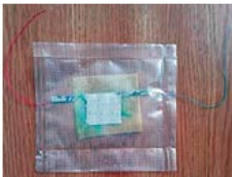
Imaginile prezintă un prototip de supercapacitor flexibil și curba de încărcare-descărcare în timp. La tensiunea de alimentare cu 1 V s-a obținut o rezistență electrică în serie de 6.90 \Omega și o capacitate de 8.64 Farad. Aceste rezultate sunt promițătoare, însă integrarea supercapacitorilor flexibili în articole purtabile mai necesită studiu. S-au utilizat totodată materiale prietenoase cu mediul
