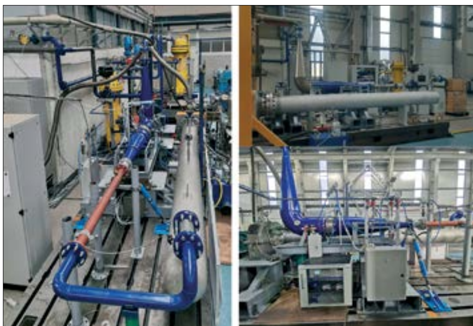
Fig.2 Banc de testare a etanșărilor cu labirinți rotativi realizat de INCD Turbomotoare COMOTI în cadrul proiectului AIRSEAL
