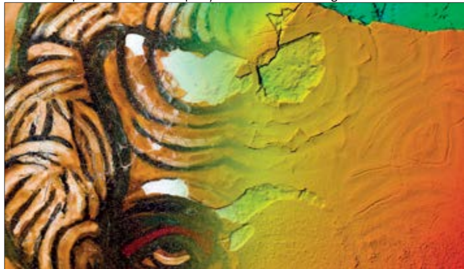
Colaj digitizare 3D macro a unui fragment de icoana pictată pe lemn (din studiul realizat în cadrul DataFusionArt: Angheluță, L. M. and Rădvan, R.: Macro photogrammetry for the damage assessment of artwork painted surfaces, Int. Arch. Photogramm. Remote Sens. Spatial Inf. Sci. , XLII-2/W15, 101–107, https://doi.org/10.5194/isprs-archives-XLII-2-W15-101-2019 , 2019)
