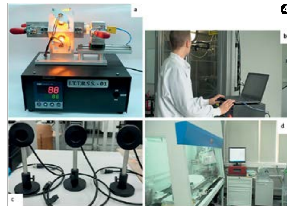
a) cuptor de tratament termic rapid; b) instalație de electrofilare; c) detectori piroelectrici pentru energimetre laser; d) mașina de printare pentru celule solare de tip perovskit
