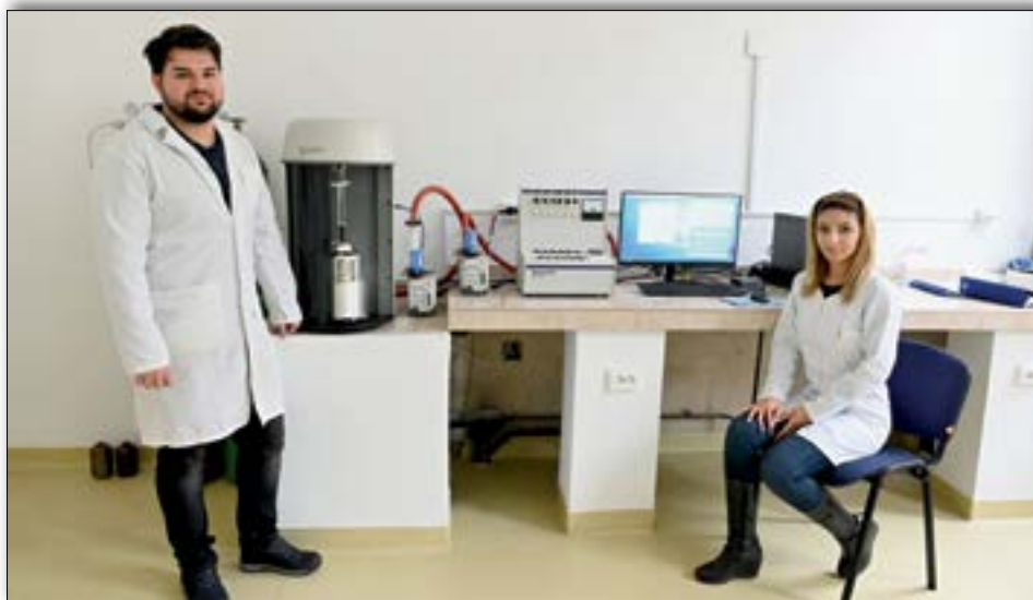
Analizor de suprafață specifică BET și porozitate TriStar II Plus (Micromeritics, SUA)
