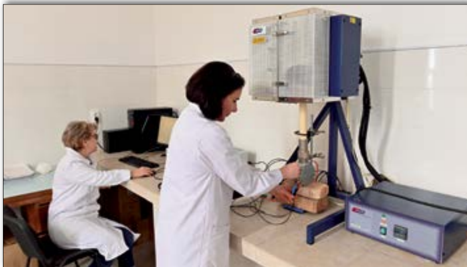
Sistem ProboStat (Norecs, Norvegia) prevăzut cu un cuptor pentru măsurători de impedanță la temperaturi ridicate, conectat la un potențiosat Autolab PGSTAT 128 N (Metrohm, Olanda)
