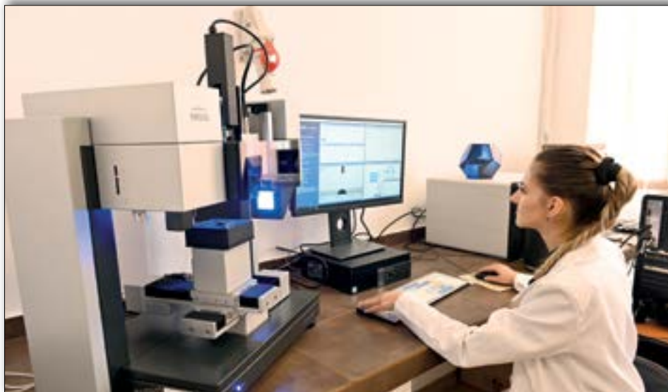
Aparat DSA 100 (Kruss, Germania) pentru măsurarea unghiului de contact
