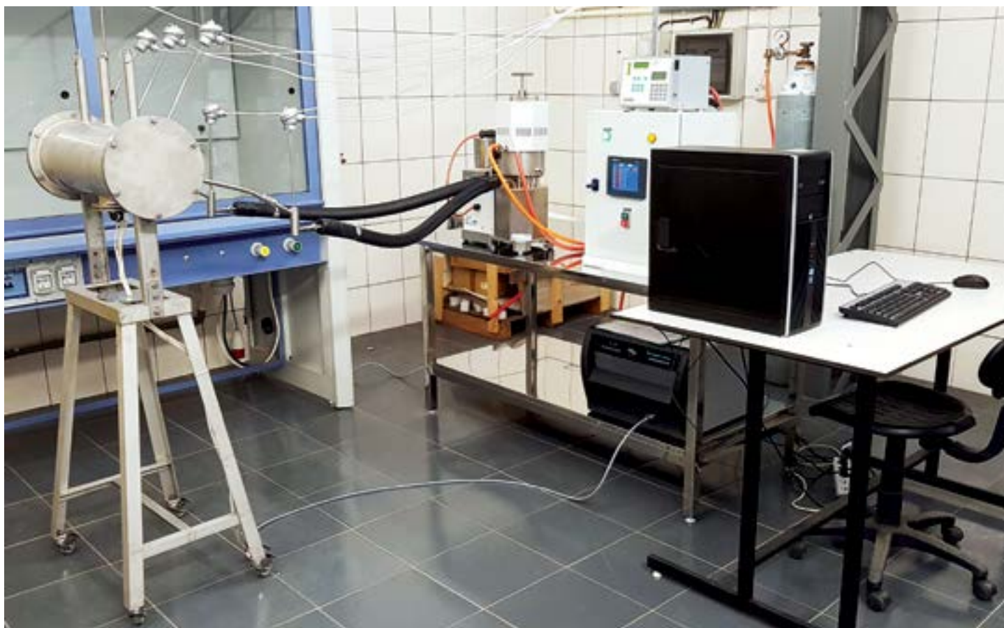
Instalație pilot pentru măsurarea capacității de stocare a energiei în materiale cu schimbare de fază. Domeniu de temperaturi 20-350°C, sistem Hot Disk de măsurare a conductivității termice
