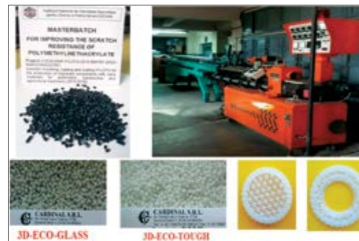
Fig. 2 Sus: granule de concentrat (stânga) și materiale obținute prin extrudare (dreapta); jos: material pe bază de polimer de proveniență regenerabilă pentru reperi auto printate 3D
