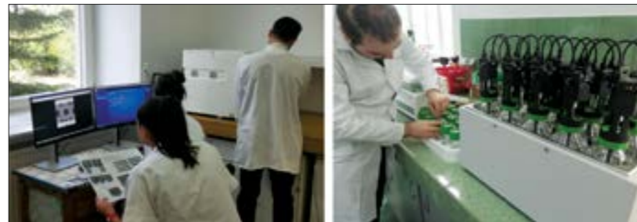
Echipe achiziționate în cadrul proiectului (stânga - microscop electronic de scanare, dreapta - sistem de determinare a potențialului metanogen)
