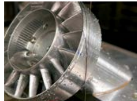
Figura 3. Stator turbină după printare și prelucrarea mecanică a suprafețelor
