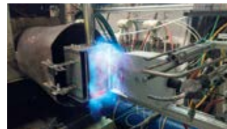
Figura 4. Stabilizator de flacăra fabricat aditiv și testat
